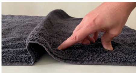
Slika 46: Mehanizem nastanka gube, ki deformira brisačo
