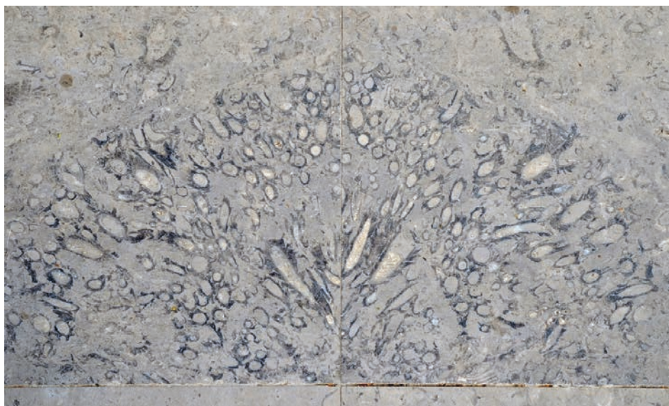
Figura 23: Lastre di calcare di Lipica con sezione trasversale di un cluster di rudiste nella pavimentazione del Centro di Accoglienza del Parco delle Grotte di Škocjan (Foto: Matevž Novak)
