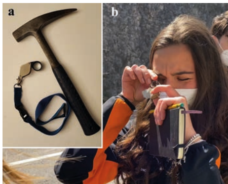
Slika 2.14 a) Dve glavni orodji za opazovanje kamnin na površju: geološko kladivo in ročna lupa. b) Pravilen način opazovanja z ročno lupo. Povečevalno steklo je treba držati blizu očesa, da je vidno polje čim večje, nato pa vzorec s svežo površino približujemo, dokler ga ne vidimo ostro. Za boljšo vidnost teksture kamnine in njenih sestavin, zlasti pri opazovanju karbonatnih kamnin, je pomembno, da opazovano površino navlažimo. (Foto: Oddelek za matematiko, informatiko in vede o Zemlji Univerze v Trstu)
