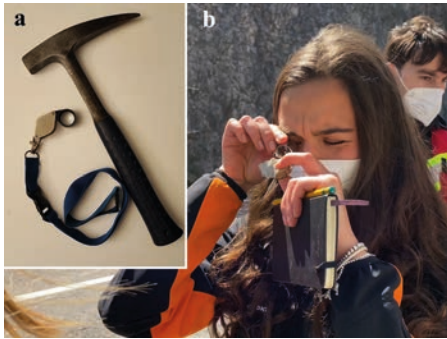
Fig. 2.14 a) I due principali strumenti per l'osservazione delle rocce in affioramento: il martello da geologo e la lente di ingrandimento. b) come utilizzare correttamente la lente di ingrandimento. La lente va tenuta vicino all'occhio in modo da avere il maggior campo visivo possibile e poi il campione, che deve presentare una frattura fresca deve essere avvicinato fino ad essere messo a fuoco. Per migliorare la visibilità della tessitura della roccia e dei suoi componenti, specialmente quando si osservano rocce carbonatiche, è importante bagnare la superficie che viene osservata.
