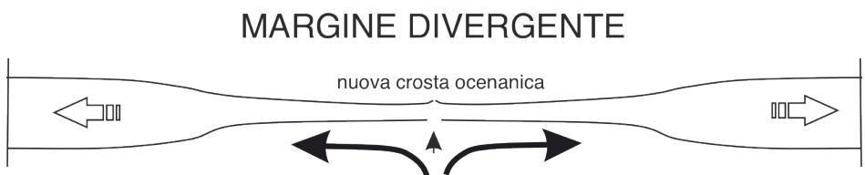
Fig. 2.7 Schema di un margine divergente con la creazione di nuova crosta oceanica. (Schema: Lorenzo Bonini)
